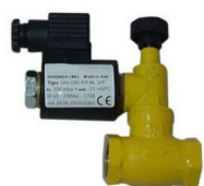
ELECTROVÁLVULA 3/4" NORMALMENTE ABERTA, REARME MANUAL 0,5 BAR, 220 V
