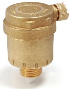
**R88 PURGADOR DE AR****REF:** 51006030000087-P**8,53€ +IVA**Campo de temperatura: **5÷120 °C**Pressão máxima de trabalho: **14 bar**Pressão máxima de descarga: **7 bar****Categorias:** [Acessórios](#), [Caldeiras e Queimadores](#), [Climatização](#)
